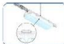
INSTALACIÓN CON GRAPA METALICA
