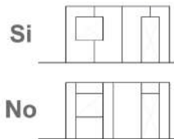
Esquema instalación de planchas sobre vanos:
