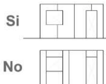
Esquema instalación de planchas sobre vanos:
