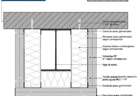
Esquema de protección contra el fuego de estructuras metálicas, vigas y pilares cuando existan.
