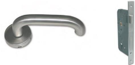
**Cerradura de Seguridad** \_1074 AL CIL/MAR. Cerradura de embutir backset de 40mm seguro interior/cilindro exterior cerrojo de dos pitones una vuelta de llave, Acabado inox satin. Marca SCN.
