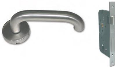
**Cerradura de Seguridad** \_1074 AL CIL/MAR. Cerradura de embutir backset de 40mm seguro interior/cilindro exterior cerrojo de dos pitones una vuelta de llave, Acabado inox satin. Marca SC
