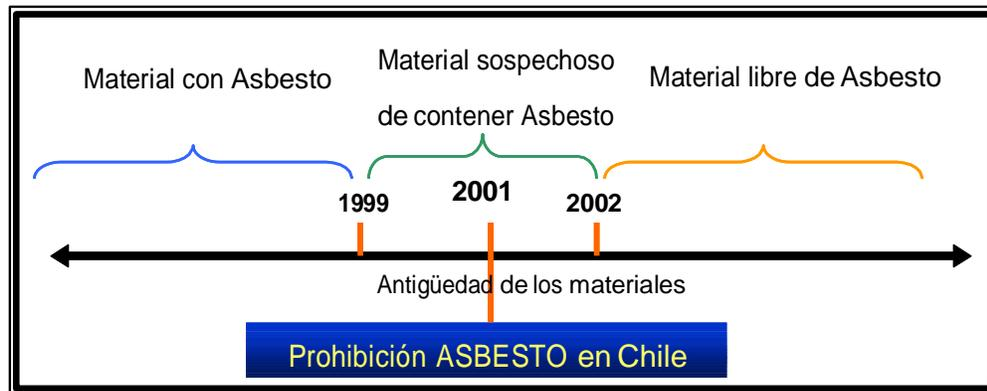
Establecer, de forma aproximada, la antigüedad del material de asbesto-cemento y su uso considerando si esta expuesto o no a inclemencias climáticas. Estos son factores a considerar para el manejo de estos materiales ya que marcan su estado de conservación o deterioro.
