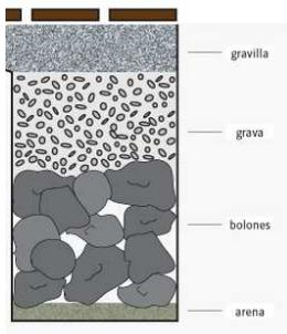
El pozo de drenaje debe considerar rejilla metálica, en base a marco de acero perfil ángulo 50/50/3 mm con anclaje metálico y rejilla de pletina metálica.
