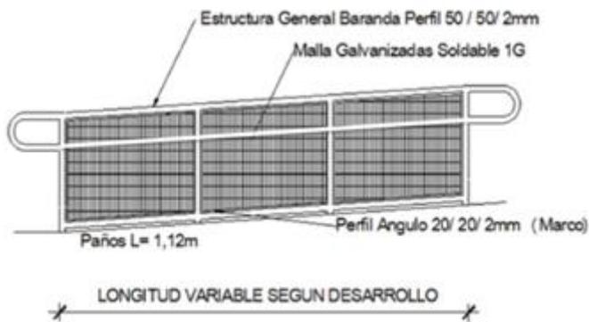
En general, en todos los pavimentos del jardín en los que existe un desnivel superior a 30 cm, se exige la colocación de una baranda metálica, de las mismas características anteriores.
